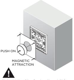
Gebruik steeds de Lithoss tool of paperclip voor het verwijderen van de afdekplaat. Always use the Lithoss push pin or paper clip for the removal of the cover plate. Verwenden Sie immer den Lithoss Push-Pin oder Büroklammer für das Entfernen der Deckplatte Utilisez toujours le Lithoss 'push pin' ou trombone pour l'écartement de la plaque de finition.
